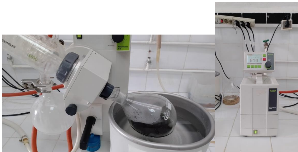
الشكل 18: يوضح جهاز المبخر الدوراني rotavapor
